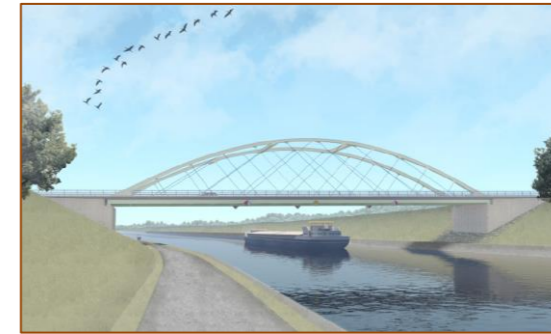
Ouvrages de type Bow-string
